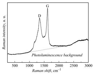
Рис. 4. Усредненный спектр КР образца сажи, полученного в пламени ацетилен-воздух на высоте 5 mm. Штриховой линией показан фон фотолюминесценции.
