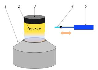
Рис. 1. Плоская горелка предварительного смешения и схема отбора проб частиц сажи: 1 — стандартная горелка типа Мак-Кенна, 2 — частицы сажи, формирующиеся в пламени, 3 стабилизатор, 4 — кварцевая пластинка, 5 — пневмоцилиндр.
