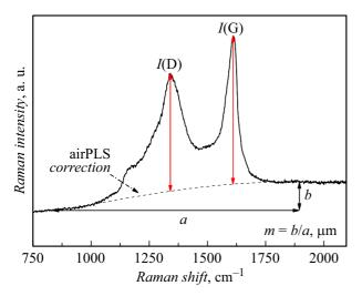
**Рис. 5.** Интерпретация спектра КР образца сажи, извлеченного из пламени ацетилен—воздух на высоте 5 mm и определение пиков интенсивности I(D), I(G) и фона фотолюминесценции m.
