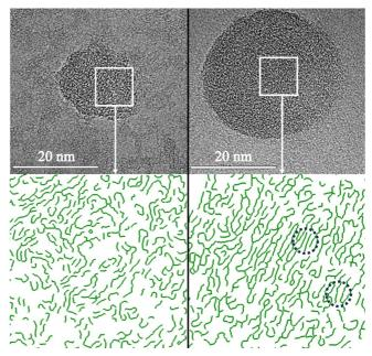
**Рис. 3.** Примеры изображения ПЭМ частиц сажи (верхняя часть) и расположения графеновых плоскостей внутри частиц (нижняя часть) [5]. Слева — "молодая" частица сажи, справа — "взрослая". Выделенные области — зоны кристаллитов.
