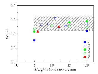
Рис. 7. Средняя длина графеновых плоскостей частиц сажи в зависимости от высоты пламени над срезом горелки. Результаты получены: 1 — методом КР в пламени этилен-воздух, 2 — методом ПЭМ в пламени этилен-воздух [5], 3 методом КР в пламени ацетилен-воздух, 4 — методом ПЭМ в пламени ацетилен-воздух [5], 5 — методом КР в пламени этилен—воздух ([C]/[O] = 0.72) [14]. Заштрихованная область показывает средний размер графеновых плоскостей  $1.25 \pm 0.1$  nm из работы [5].
