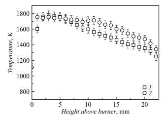
**Рис. 2.** Температурные профили в центре пламени в зависимости от высоты над срезом горелки. Топливная смесь: I — этилен—воздух, 2 — ацетилен—воздух.
