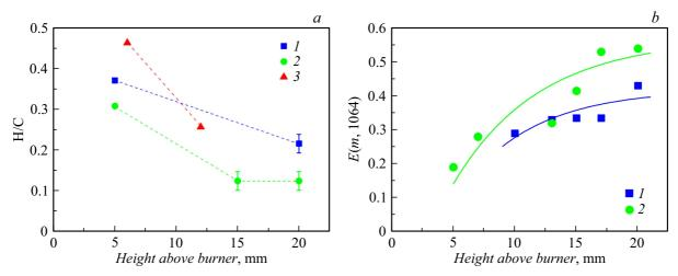
**Рис. 8.** Изменение свойств частиц сажи в зависимости от высоты над срезом горелки: a — соотношение H/C, b — E(m, 1064) из работы [5], где I — пламя этилен—воздух, 2 — пламя ацетилен—воздух, 3 — пламя этилен—воздух ([C]/[O] = 0.72) [14].
