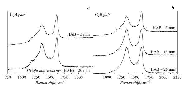
**Рис. 6.** Спектры КР частиц сажи, отобранных на различных высотах пламени этилен—воздух (a) и ацетилен—воздух (b).
