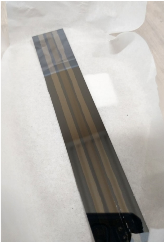
Рис. 6. Экспериментально полученное многостриповое многослойное зеркало для двухзеркального монохроматора синхротрона СКИФ.
