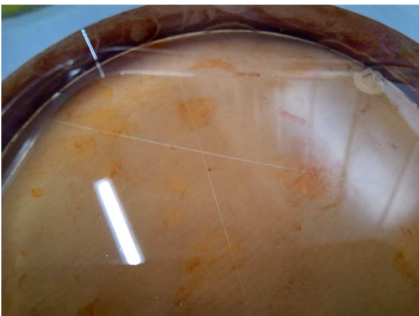
Рис. 7. Полосы 200\ \mu\text{m} , сформированные на вогнутой сферической подложке.
