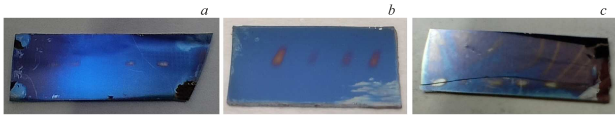
Рис. 7. Фотография проэкспонированных и проявленных образцов. \lambda , nm: a — 11.2, b — 13.9, c — 30.4.
