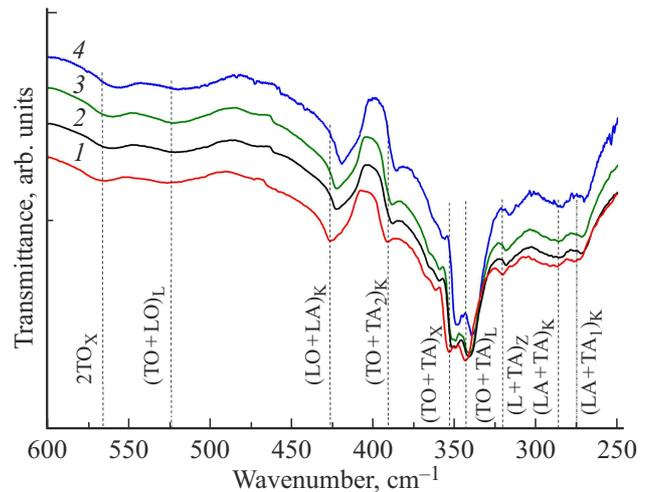
Рис. 1. ИК-спектры пропускания монокристаллов изотопов германия при  $T = 298 \text{ K}$ : кривая 1 —  $^{72}\text{Ge}$ , 2 —  $^{73}\text{Ge}$ , 3 —  $^{72}\text{Ge}_{0.5}^{74}\text{Ge}_{0.5}$ , 4 —  $^{74}\text{Ge}$ . Отнесение фононов [11]. Спектры сдвинуты по оси ординат для удобства.
