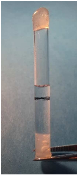
Образец геля в стеклянном капилляре, герметизированном с двух сторон полимерными крышками.
