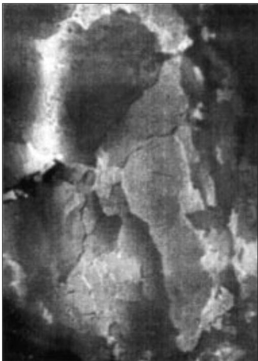
Рис. 1. Рентгеновская топограмма кристалла КМЦРТ: отражение (422), увеличение  $\times 16$ .
