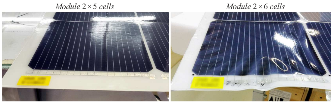
Рис. 6. Деформация полугибкого ФЭМ формата 2 × 6 ФЭП и отсутствие деформации ФЭМ формата 2 × 5 ФЭП после испытания на стойкость к местному перегреву.
