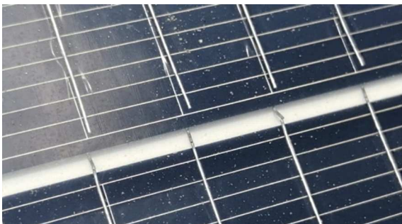
Рис. 5. Поломка проволок ППЭ SW в промежутках между ФЭП после 350 циклов термоциклирования.
