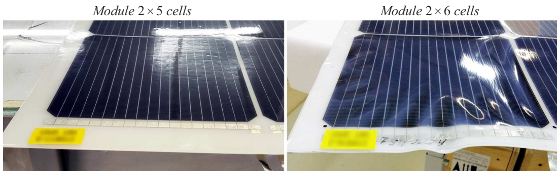
Рис. 6. Деформация полугибкого ФЭМ формата 2 × 6 ФЭП и отсутствие деформации ФЭМ формата 2 × 5 ФЭП после испытания на стойкость к местному перегреву.
