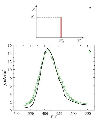
**Рис. 2.** a — Модель дискретного уровня ловушки с энергией  $W_T$  и концентрацией  $N_0$  в  $\mathrm{Si}_3\mathrm{N}_4$ , b — зависимость тока деполяризации от температуры при положительном напряжени  $4\,\mathrm{B}$  на Al. Квадраты — эксперимент, пунктирная линия — расчет для дискретного уровня с энергией  $W_T=1.15\,\mathrm{eV}$ .
