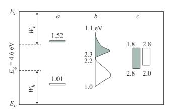
**Рис. 1.** Энергетический спектр локализованных состояний для электронов и дырок в аморфном  $Si_3N_4$  по данным разных работ. Цифры внутри рисунка обозначают значения энергии ловушек, взятые из работ: a - [19], b - [20], c - [21].
