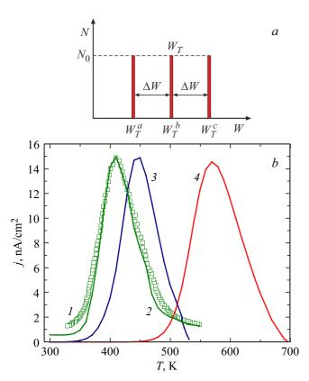
**Рис. 3.** a — модель непрерывного спектра ловушек с тремя разными уровнями энергии и одинаковой концентрацией  $N_0$ ; b — сравнение эксперимента ТСД (I — квадраты) с расчетом (2,3,4 — непрерывные линии) для модели непрерывного спектра ловушек с  $W_T^b=1.15\,\mathrm{eV}$  при напряжении деполяризации 4 V. Значения дисперсии (расстояние между уровнями ловушек  $\Delta W$ ) составляет: 2 — 0.01,3 — 0.1,4 —  $0.5\,\mathrm{eV}$ .
