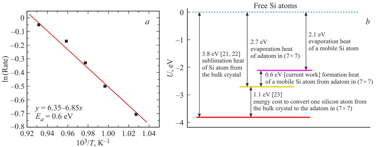
**Рис. 2.** *a* — аррениусова зависимость скорости образования кристаллической фазы SiN (8 × 8) от температуры на поверхности кремния с реконструкцией (7 × 7). *b* — схематичная энергетическая диаграмма для атомов кремния, находящихся в различных состояниях кристаллического Si(111) и на его поверхности.
