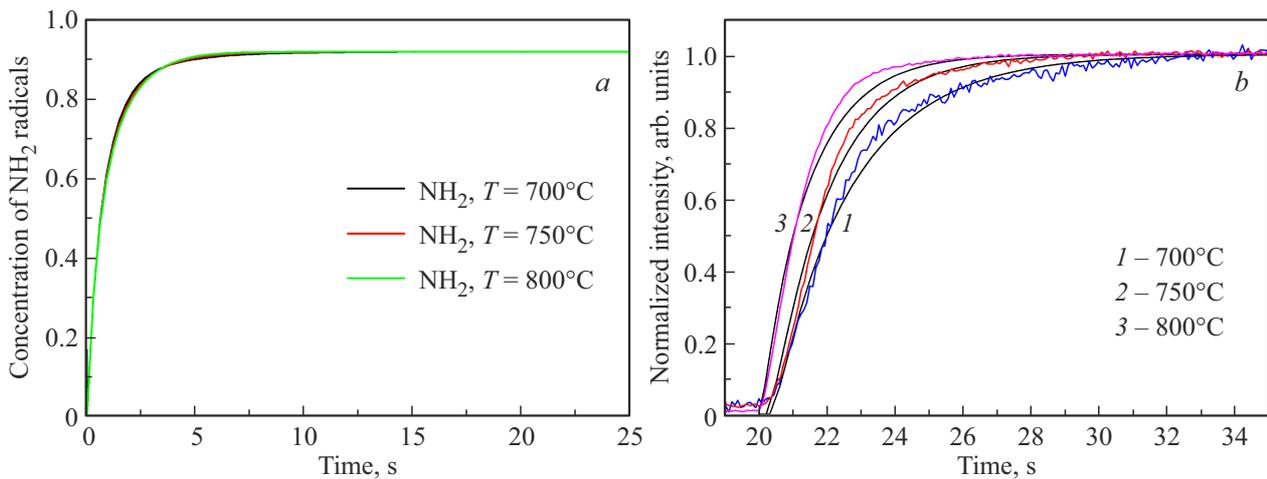
**Рис. 4.** *a* — расчетная временная зависимость концентрации радикалов  $\text{NH}_2$ , адсорбированных на поверхности кремния. *b* — сопоставление с расчетными кривыми (гладкие кривые) экспериментальных кинетических кривых (ломаные кривые с наличием шума), полученных *in situ* методом ДБЭО в процессе нитридации поверхности кремния в потоке аммиака  $27 \text{ ст. см}^3 \cdot \text{мин}^{-1}$  при разной температуре подложки, °C: 1 — 700, 2 — 750, 3 — 800.
