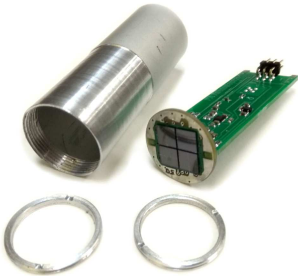
Рис. 2. Внешний вид пикселя нового детекторного кластера в разборе.
