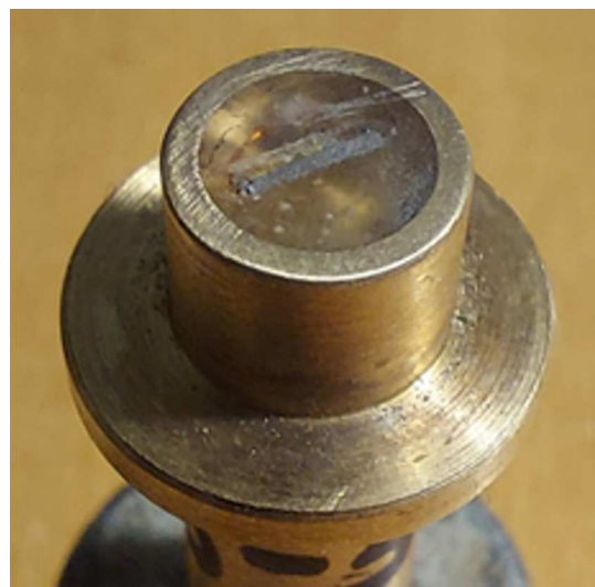
Рис. 2. Вставка с датчиком теплового потока на анизотропном термоэлементе из монокристалла висмута.
