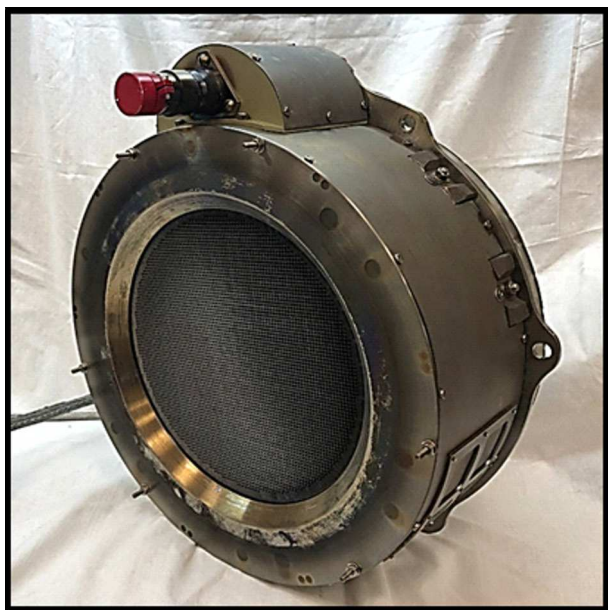
Рис. 3. Внешний вид экспериментального образца ИД-200ПМ [1].
