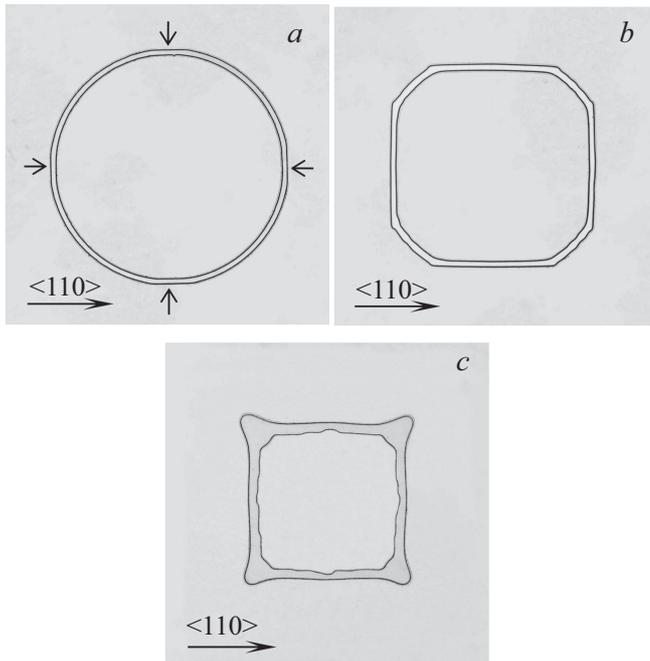
**Рис. 1.** Фотографии эпитаксиального канала, полученного при температуре ТМ 1400 К с помощью кольцевой зоны при ТМ на различных расстояниях от стартовой поверхности, мкм: 10 (а), 170 (b), 750 (c). Внешний диаметр кольцевой зоны — 2.2 мм.
