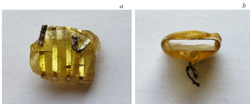
Рис. 1. Измерительная катушка для записи сигнала ЯМР от ядер ^{59}\text{Co} для нанопроволок: вид сверху ( a ) и вид сбоку ( b ).
