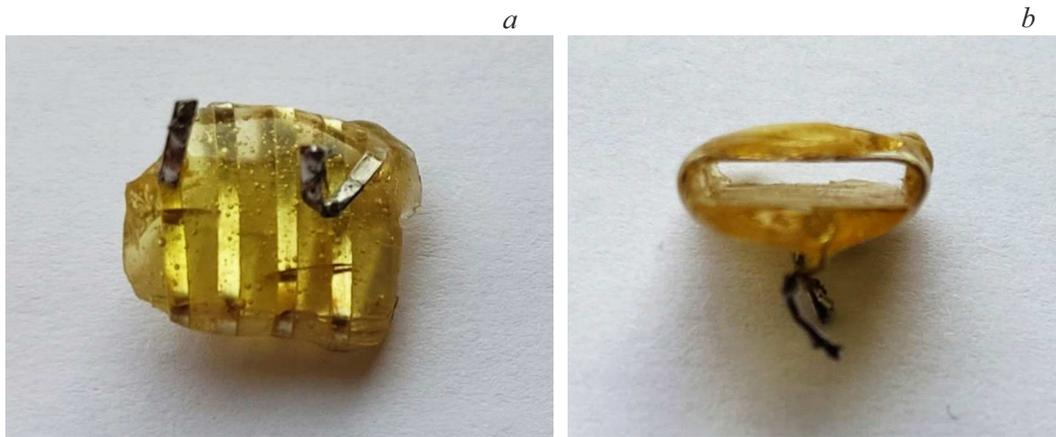
Рис. 1. Измерительная катушка для записи сигнала ЯМР от ядер  $^{59}\text{Co}$  для нанопроволок: вид сверху (а) и вид сбоку (b).
