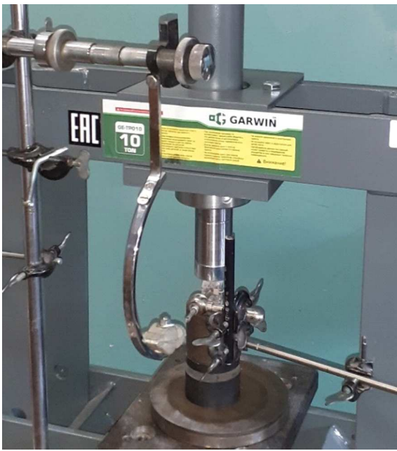
Рис. 1. Фотография установки для генерации АЭ при ударном повреждении одноосно сжатого образца ЦК.
