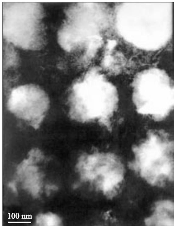
**Рис. 2.** Электронно-микроскопическое изображение области композита опал-ZnO после 25 циклов заполнения.
