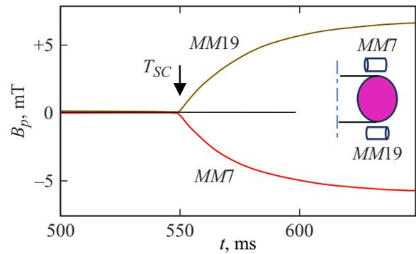
**Рис. 3.** Временная эволюция амплитуды внешнего магнитного поля при включении токов в седловых обмотках ( $T_{SC} = 550$  ms, ток в обмотках  $I_{SC} = 1250$  A), измеренная с помощью полоидальных магнитных зондов, расположенных на границе вакуумной камеры сверху и снизу относительно экваториальной плоскости тора (MM7 —  $\vartheta \approx 90^\circ$ , MM19 —  $\vartheta \approx 270^\circ$ ).
