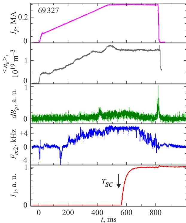
**Рис. 7.** Временная эволюция параметров плазмы в токамаке T-10 при включении резонансных магнитных полей:  $I_p$  — ток плазмы;  $\langle n_e \rangle$  — электронная плотность;  $dB_p$  — амплитуда возмущений полоидальных магнитных полей  $m = 2, n = 1$ ;  $F_{m2}$  — частота вращения моды  $m = 2, n = 1$ ;  $I_1$  — ток в седловых обмотках.
