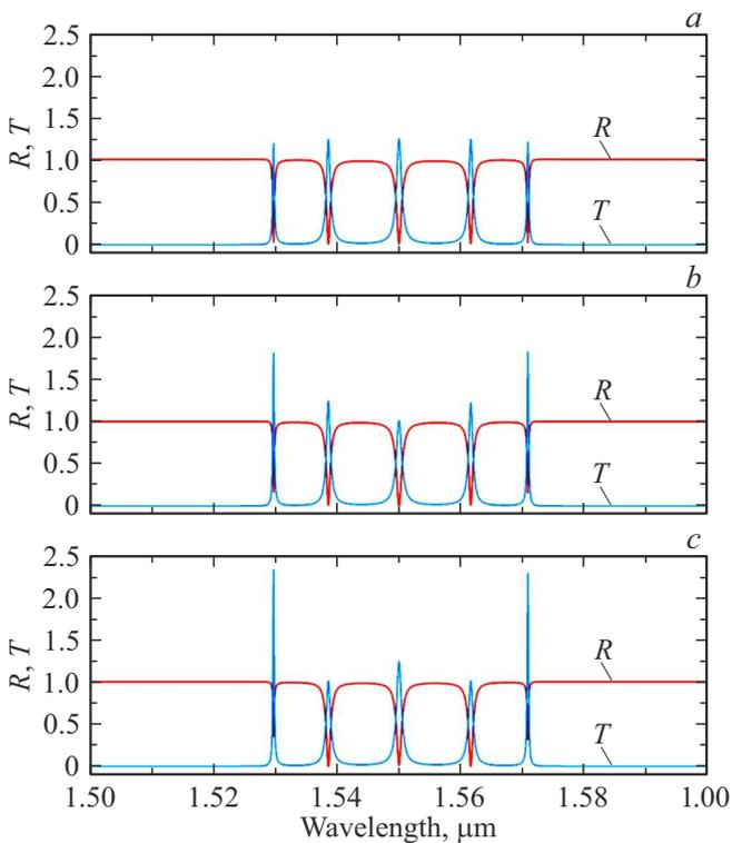
**Рис. 3.** Спектры пропускания (синие кривые) и отражения (красные кривые) МДФК с усилением в первом (а), втором (b), третьем (c) дефектных слоях. Параметры структуры: число доменов  $M = 6$ , толщина дефектных слоев  $d_D = d_A$ . Остальные параметры те же, что и на рис. 2.
