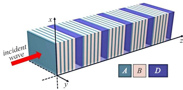
**Рис. 1.** Геометрия задачи: МДФК имеет структурную формулу  $[[AB]^N D]^M$ , где  $[AB]^N$  — брэгговские отражатели (домены), выполненные из слоев  $A$  и  $B$ ,  $N$  — число периодов  $[AB]$  в доменах,  $D$  — дефектные слои,  $M$  — число доменов (совпадает с числом дефектных слоев). Световая волна падает на МДФК со стороны слоя  $A$ .
