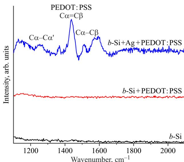
**Рис. 2.** Спектры КРС подложек черного кремния: 1 — исходная подложка черного кремния; 2 — подложка черного кремния с нанесенным на поверхность полимером PEDOT:PSS; 3 — подложка черного кремния с нанесенным на поверхность тонким слоем серебра и полимером PEDOT:PSS.
