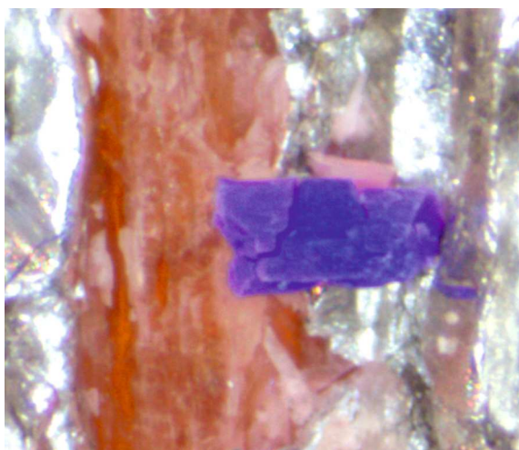
Рис. 8. Фотография монокристалла \text{CoGeF}_6 \cdot 6\text{H}_2\text{O} после длительного воздействия лазерного излучения в вакуумной камере.
