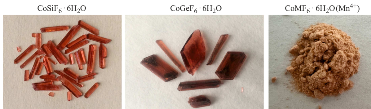
Рис. 1. Фотографии кристаллов и активированного порошка \text{CoMF}_6 \cdot 6\text{H}_2\text{O}:\text{Mn}^{4+}
