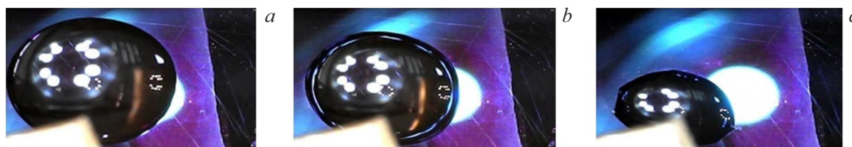
Рис. 6. Испарение капли на поверхности, характеризуемой R_{ms} = 23.1 nm. Случаи a–c соответствуют 0, 50, 100 min после начала наблюдения за испарением капли.
