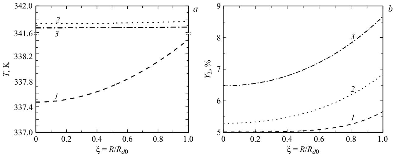
**Рис. 2.** Типичные распределения температуры (а) и концентрации твердых примесей (б) в различные моменты времени при начальной относительной массовой концентрации 5%,  $T_g = 800$  К и  $R_{d0} = 50 \mu\text{m}$ .  $t = 0.04$  (1), 0.08 (2) и 0.12 с (3).
