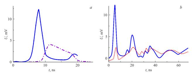
**Рис. 2.** a — временные зависимости амплитуды электрического импульса, снимаемого с пьезопреобразователя, для пленок D (штрихпунктирная кривая) и G (сплошная кривая), находящихся в нулевом магнитном поле; b — временные зависимости амплитуды электрического импульса для пленки G без магнитного поля (сплошная кривая) и в магнитном поле  $0.2\,\mathrm{T}$  (пунктирная кривая).
