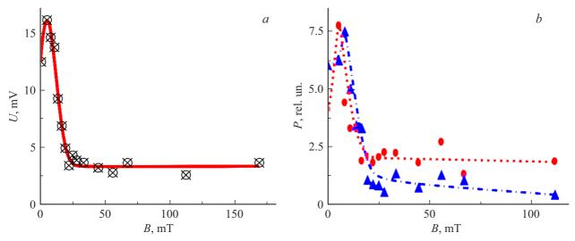
**Рис. 3.** a — зависимость амплитуды электрического импульса от индукции магнитного поля B для пленки G; b — зависимости мощности составляющих спектра на частотах  $61\,\mathrm{MHz}$  (пунктирная кривая) и  $72\,\mathrm{MHz}$  (штрихпунктирная кривая) для пленки G.
