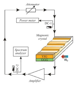
**Рис. 1.** Схематическое изображение магнонного кольцевого автогенератора на основе линии задержки с МК.
