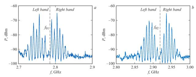
**Рис. 3.** Спектры мощности многочастотного СВЧ-сигнала, генерируемого в магнонном кольцевом автогенераторе с МК при  $H_{01}=34.22\,\mathrm{kA/m}$  (a) и  $H_{02}=37.96\,\mathrm{kA/m}$  (b). Мощность многочастотного СВЧ-сигнала на входе линии задержки с МК равна  $-15\,(a)$  и  $-14.5\,\mathrm{dBm}$  (b).
