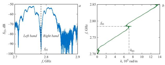
**Рис. 2.** АЧХ линии задержки на основе МК (a) и зависимость частоты от волнового числа ПМСВ (b). Измерения на обоих фрагментах выполнены для  $H_{01}=34.22\,\mathrm{kA/m}$  и мощности монохроматического СВЧ-сигнала на входе линии задержки  $-30\,\mathrm{dBm}$ .
