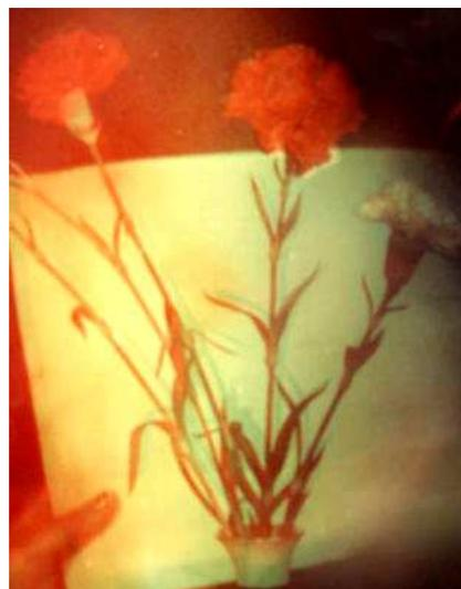
**Рис. 5.** Пример изображения, восстановленного пропускающей голограммой.
