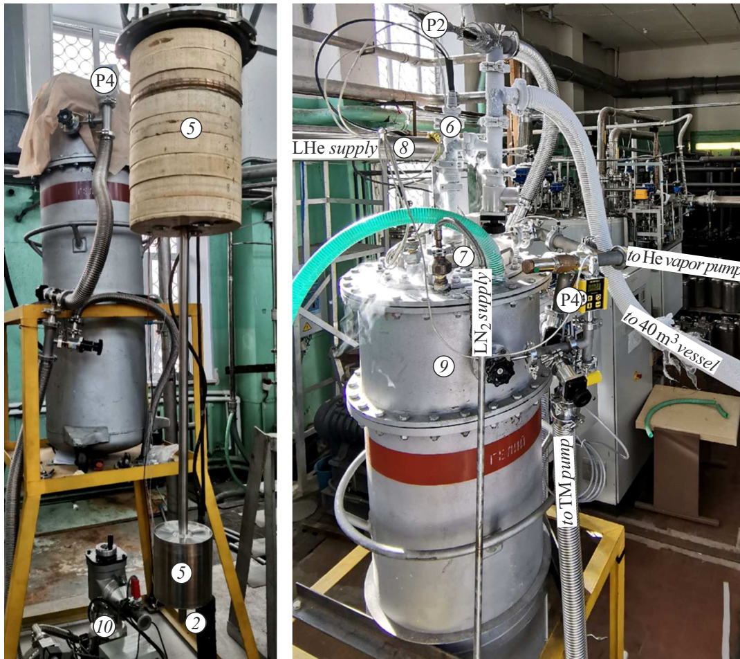
Рис. 3. Емкость SOURCE (слева) и криостат для получения ИЧГ в работе (справа).
