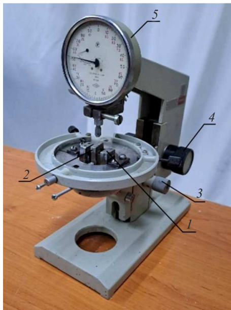
Рис. 3. Самодельная установка для измерения влияния деформации на термоЭДС толсто пленочного термоэлектрического датчика: 1 — держатель образца, 2 — подвижный зажим, 3 — ручка для перемещения зажима, 4 — ручка для перемещения микрометра 5.
