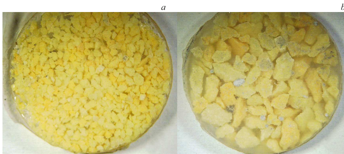
Фотографии элементов, изготовленных из композита пористая пьезокерамика–фотополимер после шлифовки до нанесения электродов. a — композит с частицами керамики 0.5–1.0 mm, b — композит с частицами керамики 1.0–2.0 mm. Диаметр дисков составляет 20 mm.
