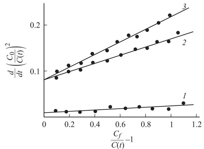
Рис. 2. Релаксационные зависимости неравновесной емкости МОП структуры в координатах  $(d/dt)(C_0/C(t))^2$  и  $(C_f/C(t) - 1)$ : 1 — до  $\gamma$ -облучения, 2 — после  $\gamma$ -облучения, 3 — после  $\gamma$ -облучения и ультразвуковой обработки.
