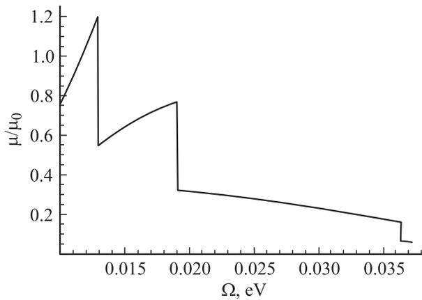
**Рис. 2.** Зависимость поперечной подвижности носителей  $\mu$  от штарковской частоты  $\Omega$ . Параметры расчета:  $\Delta \approx 10^{-2}$  эВ,  $\omega_0 \approx 2 \cdot 10^{13}$  с $^{-1}$ ,  $d \approx 2 \cdot 10^{-6}$  см,  $T \approx 100$  К,  $\mu_0 \approx 10^5$  см $^2$ /(В · с).
