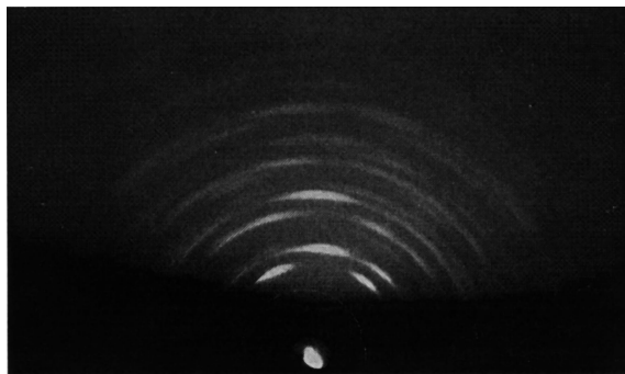
Рис. 3. Электронограмма от пленки (\text{Zn}_{0.7}\text{Cd}_{0.3}\text{Te})_{0.99}(\text{In}_2\text{Te}_3)_{0.01} , выращенной при температуре подложки T_s = 473 К и плотности падающего потока \sim 10^{15} \text{ см}^{-2} \text{ с}^{-1} .
