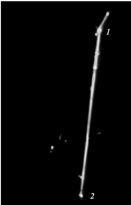
**Рис. 2.** Изображение в оптическом люминесцентном микроскопе наностержня ZnO (длиной 140 мкм) с зеркалом из алюминия на торце 1 и свободным торцом 2.
