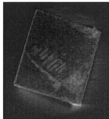
**Рис. 5.** Катодолюминесцентное изображение образца A196 со стороны поверхности роста. Обозначены области дефектов пленки, выросших на внутренних напряжениях и дислокациях, распространяющихся от трещины с левого края на подложке из природного алмаза.
