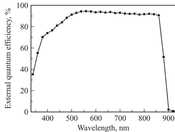
**Рис. 7.** Спектр фототока солнечного элемента на основе GaAs.
