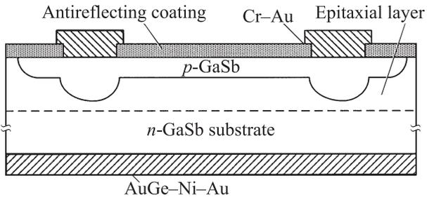
Рис. 9. Структура солнечного элемента на основе GaSb.
