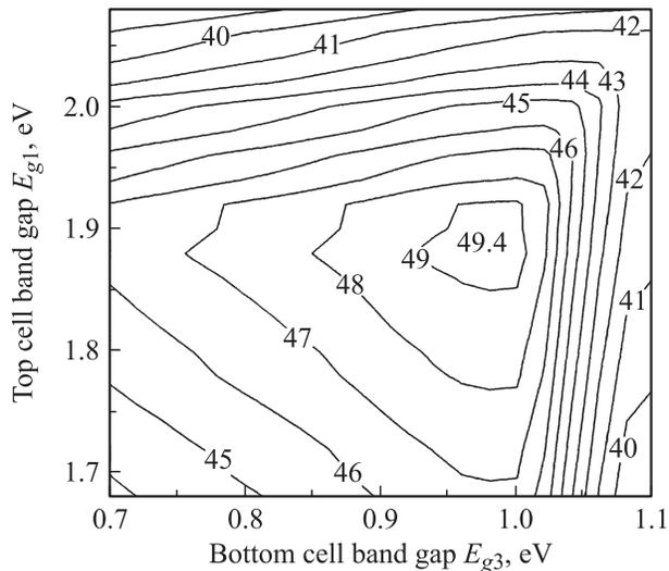
**Рис. 3.** Расчетная эффективность модуля со спектральным расщеплением солнечного излучения (AM 1.5D, кратность концентрации  $K_c = 300$ ) на основе трех однопереходных элементов (средний элемент с  $E_{g2} = 1.42$  эВ) в зависимости от значений  $E_{g1}$  и  $E_{g3}$ . Указаны значения эффективности в %.
