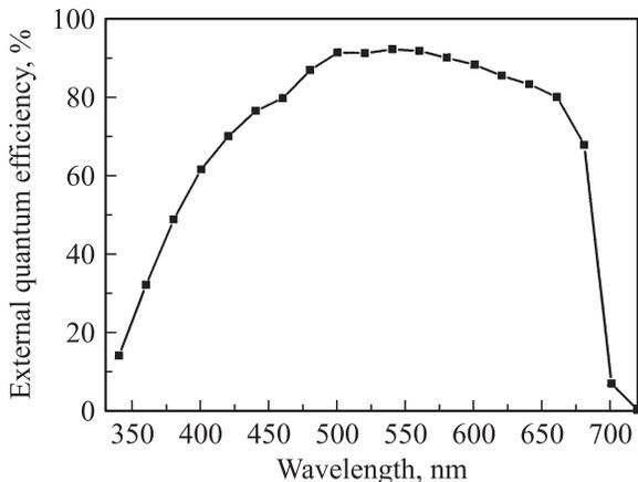
**Рис. 5.** Спектр фототока солнечного элемента на основе  $\text{Al}_{0.35}\text{Ga}_{0.65}\text{As}$ .
