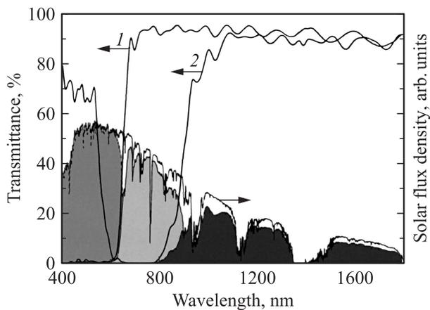
**Рис. 2.** Зависимость коэффициента пропускания селективных фильтров от длины волны падающего излучения. 1 — фильтр, отражающий солнечное излучение на широкозонный элемент (2 на рис. 1), 2 — фильтр, отражающий солнечное излучение на средний GaAs-элемент (3 на рис. 1). Правая ось соответствует спектру солнечного излучения (AM 1.5D, Low AOD) до (верхняя кривая) и после (затемненные области под нижней кривой) расщепления светового потока селективными фильтрами.
