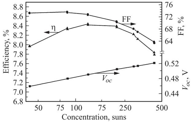
Рис. 11. Зависимости эффективности  $\eta$ ,  $V_{oc}$  и FF элемента на основе GaSb от кратности концентрирования солнечного излучения. AM 1.5D, Low AOD,  $1000 \text{ Вт/м}^2$ ,  $\Delta\lambda = 900-1840$  нм.
