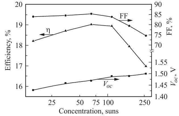
**Рис. 6.** Зависимости эффективности  $\eta$ , напряжения холостого хода  $V_{oc}$  и фактора заполнения вольт-амперной характеристики FF элемента на основе  $\text{Al}_{0.35}\text{Ga}_{0.65}\text{As}$  от кратности концентрирования солнечного излучения (AM 1.5D, Low AOD).
