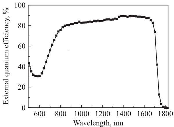
Рис. 10. Спектр фотоответа солнечного элемента на основе GaSb.
