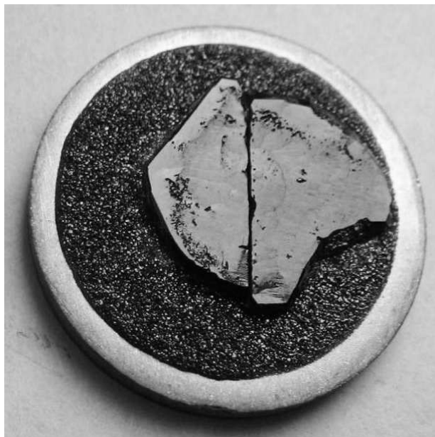
Рис. 1. Комбинированный кристалл-подложка с выращенным слоем, состоящий из 2 частей одного кристалла AlN, наклеенных встык по линии разреза на танталовый держатель: слева — вверх N-поверхностью, сплава — вверх Al-поверхностью.
