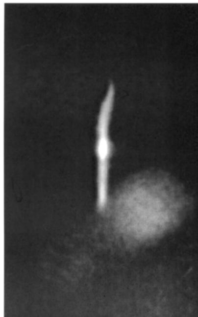
Рис. 5. Свободно локализованный стримерный СВЧ разряд в воздухе атмосферного давления с высокотемпературным ядром.
