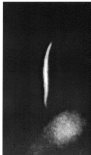
Рис. 4. Свободно локализованный стримерный СВЧ разряд в воздухе атмосферного давления.
