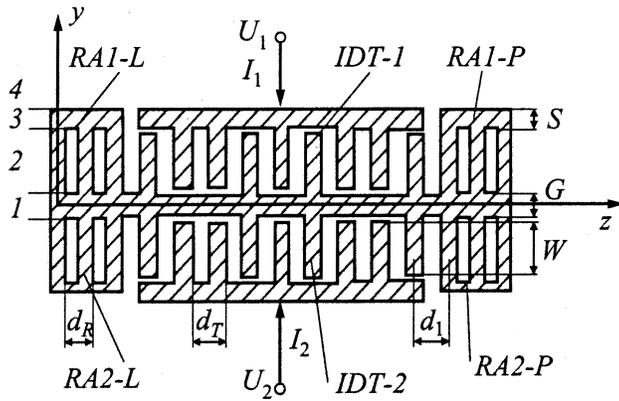
Рис. 1. Топология TCRF-фильтра.
