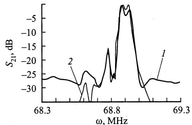
Рис. 3. Результаты измерения (1) и расчета (2) коэффициента передачи двухмодового TCRF-фильтра в несогласованном режиме.
