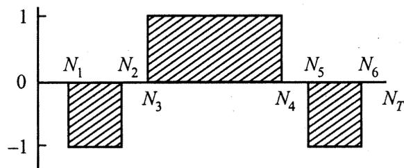
**Рис. 5.** Закон изменения полярности подключения пар электродов к контактным шинам четырехмодового TCRF.
