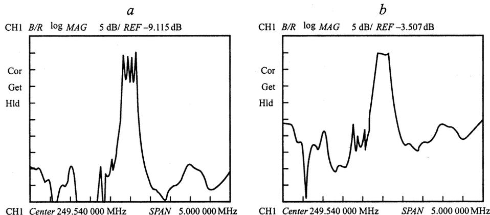
**Рис. 6.** Результаты измерения коэффициента передачи четырехмодового TCRF-фильтра в несогласованном (a) и согласованном режимах (b) из работы [6].
