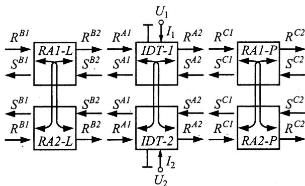
Рис. 2. Эквивалентная акустоэлектрическая схема TCRF-фильтра.
