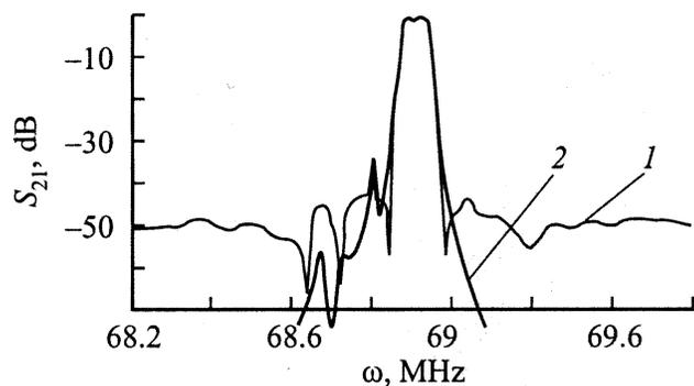
**Рис. 4.** Результаты измерения (1) и расчета (2) коэффициента передачи двух последовательно включенных TCRF-фильтров в согласованном режиме.
