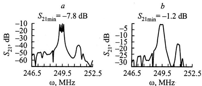
**Рис. 7.** Результаты расчета изложенным в данной работе методом коэффициента передачи четырехмодового TCRF-фильтра в несогласованном (а) и согласованном режимах (б) с данными топологии из работы [6].
