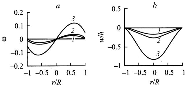
**Рис. 4.** Зависимости от радиуса упругих (1) и пластических (2, 3) углов поворота сечений (а) и прогибов (b) мембраны при температурах  $T = 1.1T_c$  (2) и  $1.05T_c$  (3).
