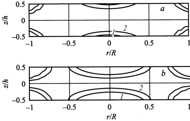
**Рис. 2.** Распределение мартенсита в радиальном сечении мембраны при температурах  $T = 1.1T_c$  (a) и  $1.05T_c$  (b) и давлении  $P = 10^{-2}E_*$ . Сечение показано в соотношении  $h/R = 0.2$ .
