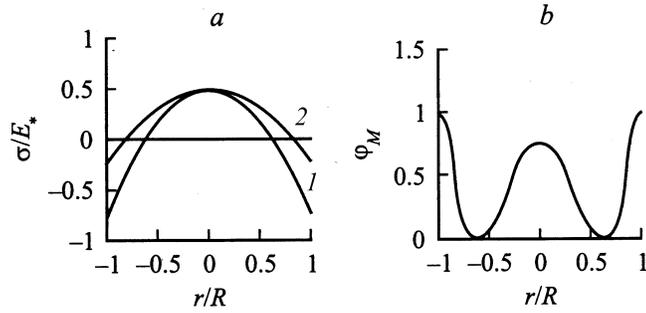
**Рис. 1.** Распределение радиальных (1) и тангенциальных (2) изгибных напряжений (а) и мартенсита (b) в нижнем поверхностном слое нагруженной давлением мембраны.
