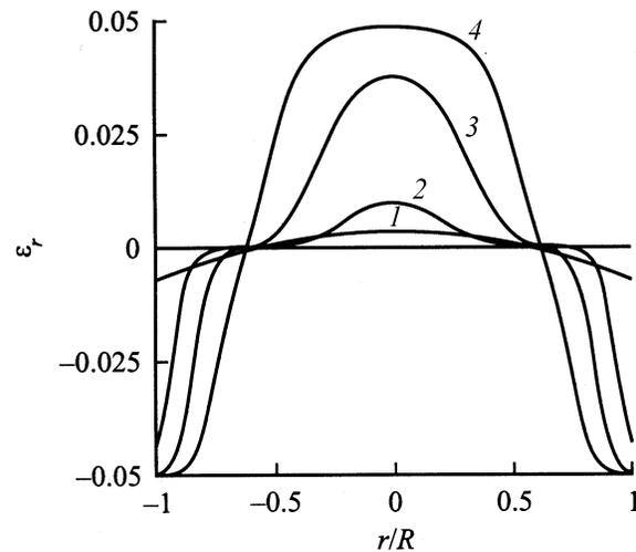
**Рис. 3.** Зависимость от радиуса упругих (1) и пластических (2–4) радиальных деформаций в нижнем поверхностном слое мембраны при температурах  $T = 1.1T_c$  (2),  $1.05T_c$  (3) и  $T_c$  (4).
