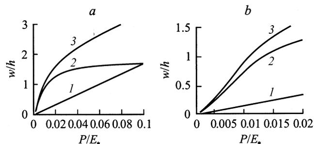
**Рис. 6.** Зависимости упругого (1), пластического (2) и суммарного (3) прогибов мембраны от давления при температуре  $T = 1.05T_c$ . (a). Начальные участки кривых (1-3) (b).
