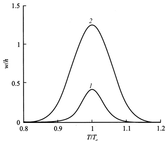
**Рис. 5.** Температурные зависимости пластических прогибов мембраны при давлениях  $P = 2 \cdot 10^{-3}E_*$  (1) и  $10^{-2}E_*$  (2).
