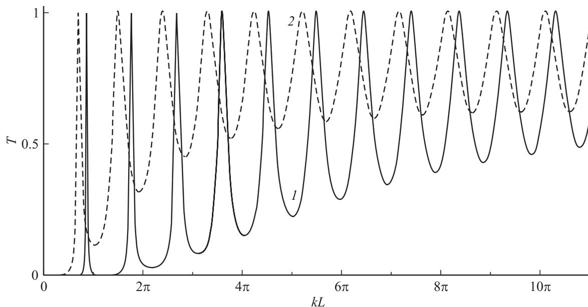
**Рис. 3.** Зависимость коэффициента прохождения  $T$  наноструктуры от волнового числа электрона при нулевом (или целочисленном) потоке магнитного поля, пронизывающего кольцо, для разных значений длины рассеяния,  $\lambda$ , нм: 1 — 75, 2 — 250.
