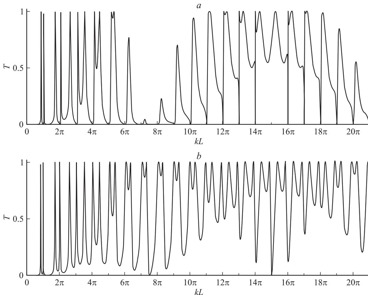
**Рис. 5.** Зависимость коэффициента прохождения  $T$  от волнового числа электрона в случае несимметричного расположения контактов на кольце ( $\phi_1 = 0$ ,  $\phi_2 = 14\pi/15$ ).  $a$  — в отсутствие магнитного поля;  $b$  — при наличии магнитного поля:  $\eta = 0.07$ .
