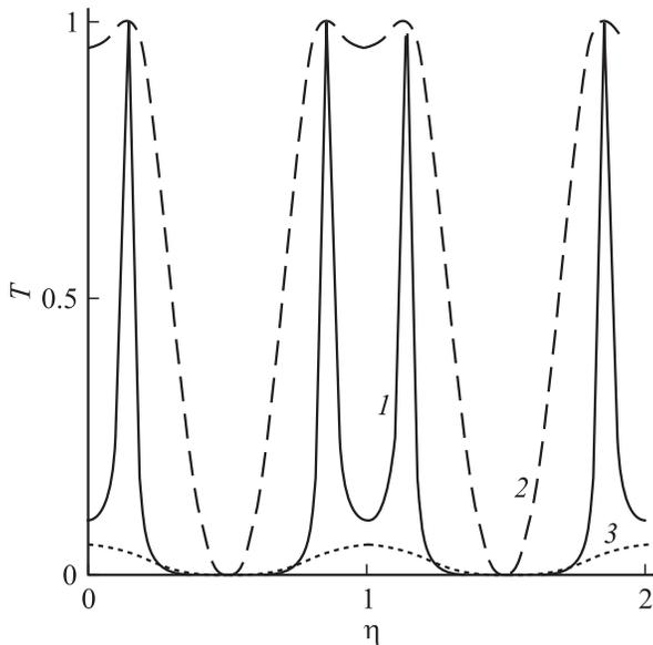
**Рис. 2.** Зависимость коэффициента прохождения  $T$  наноструктуры от потока магнитного поля, пронизывающего кольцо, при фиксированных значениях энергии электронов.  $kL$ : 1 —  $2.9\pi$ , 2 —  $2.7\pi$ , 3 —  $2.4\pi$ . Длина рассеяния электронов в областях контактов  $\lambda = 75$  nm. Здесь и далее расчет проводился для кольца радиуса  $\rho = 350$  nm.
