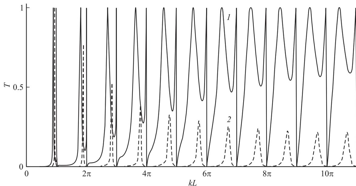
**Рис. 4.** Зависимость коэффициента прохождения  $T$  наноструктуры от волнового числа электрона при наличии магнитного поля  $\eta$ : 1 — 0.14, 2 — 0.47. Здесь и далее длина рассеяния  $\lambda = 75$  нм.
