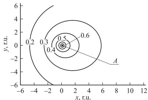
Рис. 1. Изолинии отношения  $T/W$  при  $\text{Pe} = 0.1$ . A — положение источника тепла.
