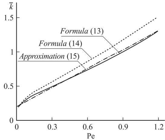
Рис. 4. Расчетные зависимости безразмерного коэффициента теплоотдачи от числа Пекле. Номера формул — у кривых.
