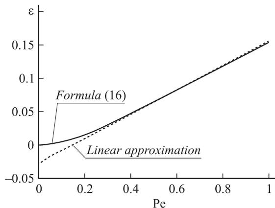
**Рис. 5.** Относительная доля конвективного потока тепла в зависимости от числа Пекле.
