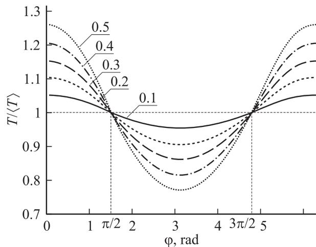
Рис. 3. Распределение относительной температуры на поверхности  $r = 1$  при различных числах Пекле (цифры у кривых) для линейного источника тепла в зависимости от полярного угла  $\varphi$ .
