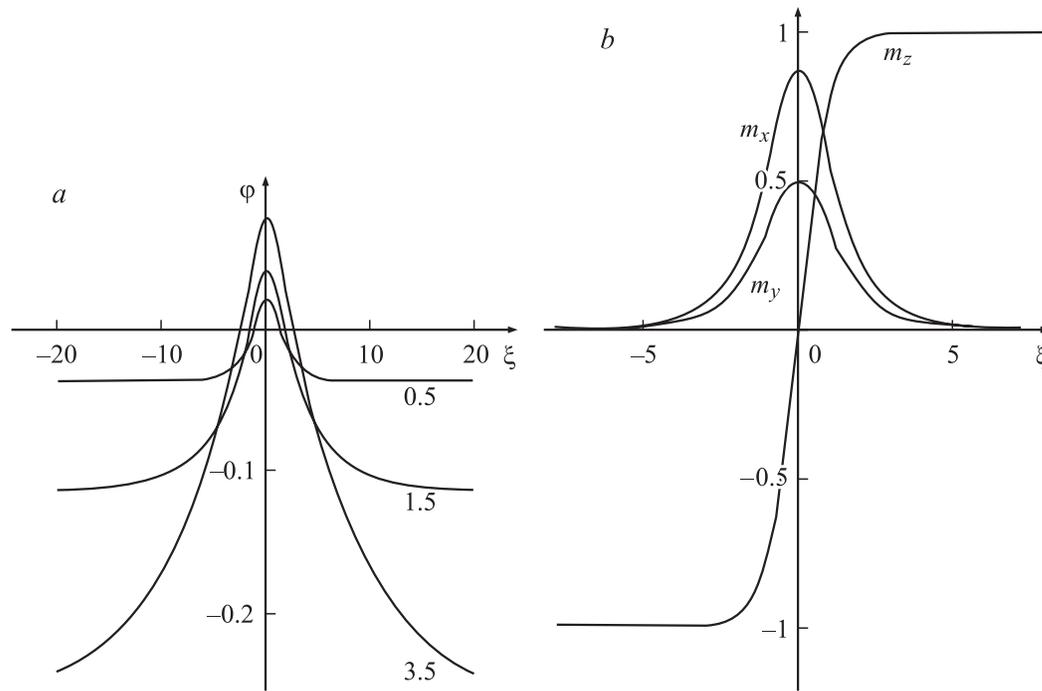
**Рис. 7.** Распределение намагниченности в переходном слое для  $180^\circ$  ДГ в случае  $\kappa_p = -0.2$ ,  $\kappa_1 = -0.3$ ,  $\kappa_2 = -0.3$  и зависимость угла  $\varphi$  от координаты  $\xi$  для различных значений  $Q$  (около кривых) (a) и компонент намагниченности от  $\xi$  для  $Q = 0.5$  (b).
