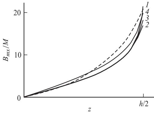
Поле  $B_{mx}$ , вычисленное по формулам (1)–(4) и получаемое методом динамического установления для скрученной ДС (пунктир).
