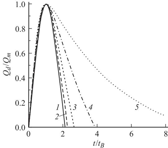
**Рис. 3.** Зависимости заряда диодов от времени, полученные путем численного решения уравнения (5) при  $\chi = 0$ ,  $U_{CB} = 0$  и различных значениях параметра  $\psi$ : 1 — 0.01, 2 — 0.1, 3 — 1.0, 4 — 10, 5 — 100.
