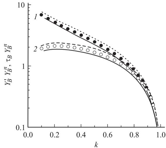
Рис. 5. Зависимости нормированных коэффициентов обострения (1) и перенапряжения (2) от коэффициента полезного действия  $k$  при  $\xi = 0$  и  $n = 2$  (сплошные линии),  $n = 3$  (пунктир). Значки — аппроксимации по формуле (33) для значения  $n = 2.5$ .
