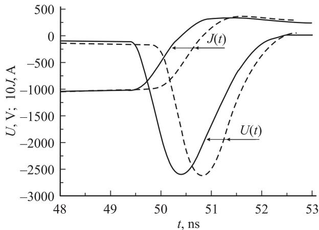
**Рис. 6.** Зависимости напряжений и токов через ДДРВ на основе Si (штриховые линии) и SiC (сплошные линии) от времени, полученные путем численного моделирования процесса обрыва тока. Параметры ДДРВ и контура приведены в таблице.
