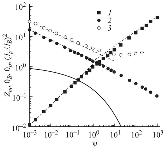
**Рис. 4.** Зависимости безразмерных амплитуды  $Z_m$  (1), длительности фронта  $\theta_B$  (2), длительности импульса  $\theta_p$  (3) и доли энергии, сохранившейся в индуктивности в конце импульса  $J^2(t_p)/J_B^2$  (сплошная линия), от параметра  $\psi$  при  $\chi = 0$  и  $U_{CB} = 0$ . Результаты расчетов для предельных случаев по формулам (23) и (25) показаны штриховыми и штрихпунктирными линиями соответственно.
