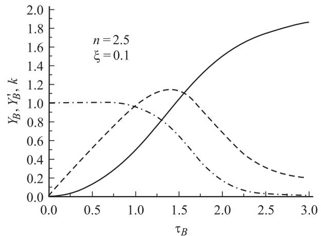
**Рис. 2.** Зависимости безразмерных заряда (сплошная кривая), тока (штриховая) и коэффициента полезного действия (штрихпунктир) от безразмерной длительности фазы высокой обратной проводимости при  $n = 2.5$  и  $\xi = 0.1$ .
