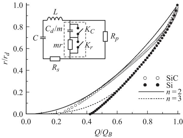
**Рис. 1.** Зависимости сопротивления карбид-кремниевых и кремниевых ДДРВ от извлеченного в течение фазы высокой обратной проводимости заряда. Значки — результаты точного моделирования процесса восстановления, кривые — расчет по формуле (4) при  $n = 2$  и  $3$ . Параметры ДДРВ и контура приведены в таблице. На вставке — эквивалентная схема контура, в котором происходит быстрый обрыв тока полупроводниковыми диодами.
