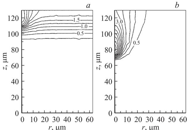
**Рис. 1.** Линии равного уровня температуры, проведенные с шагом  $500^\circ\text{C}$ . В разрывах линий указана температура в  $1000^\circ\text{C}$ . *a*:  $I_0 = 1 \text{ MW/cm}^2$ ,  $t = 80 \mu\text{s}$  ( $P = 0.5 \text{ MW}$ ,  $r_0 = 4 \mu\text{m}$ ); *b*:  $I_0 = 4 \text{ MW/cm}^2$ ,  $t = 210 \mu\text{s}$  ( $P = 4 \text{ MW}$ ,  $r_0 = 4 \mu\text{m}$ ).
