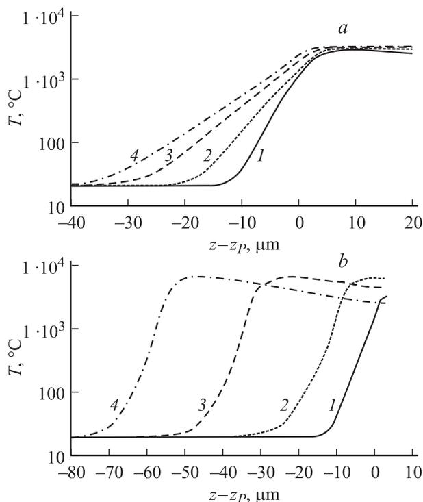
**Рис. 2.** Распределение температуры по длине  $T(t, z, r = 0)$  в различные моменты времени для  $I_0 = 1 \text{ MW/cm}^2$ ,  $P = 0.5 \text{ MW}$ ,  $r_0 = 4 \mu\text{m}$  (*a*) и  $I_0 = 4 \text{ MW/cm}^2$ ,  $P = 4 \text{ MW}$ ,  $r_0 = 4 \mu\text{m}$  (*b*).  $t, \mu\text{s}$ : *a* — 10 (1), 38 (2), 66 (3), 80 (4); *b* — 10 (1), 90 (2), 170 (3), 210 (4).
