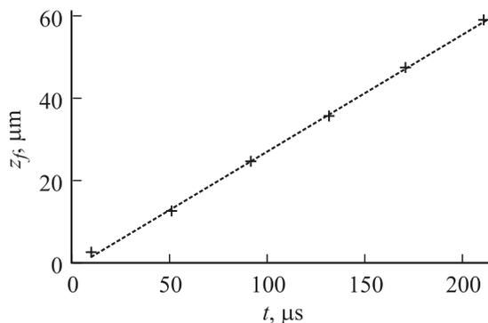
**Рис. 3.** Зависимость координаты  $z_f$  фронта тепловой волны пробега от времени  $t$ . Координата фронта  $z_f$  определяется как точка, в которой  $T(t, z_f, r = 0) = T_p = 2000 \text{ K}$ . Пунктир —  $z_f(t) = v_f t + \text{const}$ , где  $v_f = 0.29 \text{ m/s}$ .  $I_0 = 4 \text{ MW/cm}^2$ ,  $P = 4 \text{ MW}$ ,  $r_0 = 4 \mu\text{m}$ .
