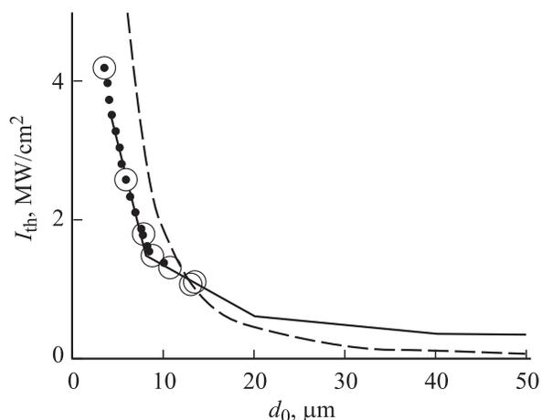
**Рис. 5.** Зависимость пороговых значений интенсивности от диаметра сердцевин световода  $d_0$ . Значки — экспериментальные данные [12], сплошная кривая — результаты расчетов, штриховая — оценка (5).
