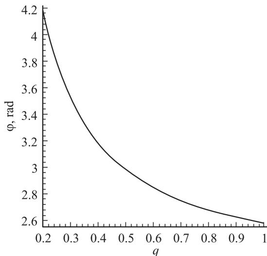
Зависимость разности фаз  $\varphi$  от коэффициента аккомодации тангенциального импульса при  $\lambda/\delta = 0.2$ .
