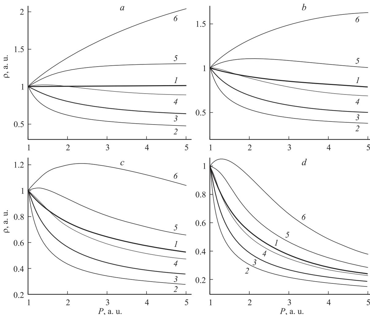
**Рис. 5.** Распределение относительной плотности газа в зависимости от давления для нескольких значений параметра  $\beta = 1$  (a), 0.8 (b), 0.6 (c), 0.4 (d). Средняя плотность в активном объеме 1,  $z/h = 0$  (2), 0.25 (3), 0.5 (4), 0.75 (5),  $z/h = 1$  (6).
