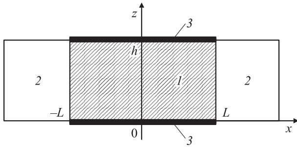
**Рис. 1.** Схема герметичной кюветы с буферными объемами: 1 — активный объем, 2 — буферный объем, 3 — пластины с делящимся материалом.
