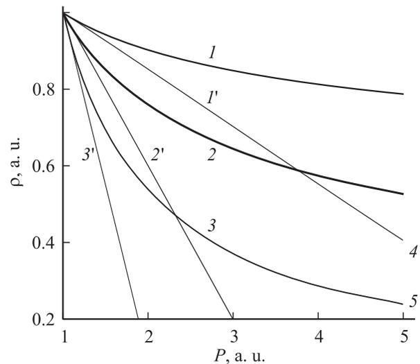
**Рис. 3.** Зависимость средней плотности в активном объеме от давления для нескольких значений параметра  $\beta = 0.8$  (1, 1'); 0.6 (2, 2'); 0.4 (3, 3') (штрихи у цифр расставлены для приближения малого энерговклада).
