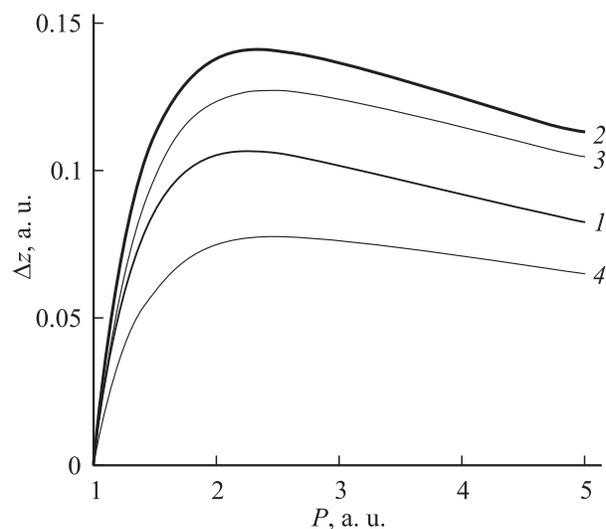
**Рис. 4.** Смещение жидких частиц в направлении оси  $Oz$  в зависимости от давления для параметра  $\beta = 0.4$ :  $z_0/h = 0.2$  (1), 0.4 (2), 0.6 (3), 0.8 (4).
