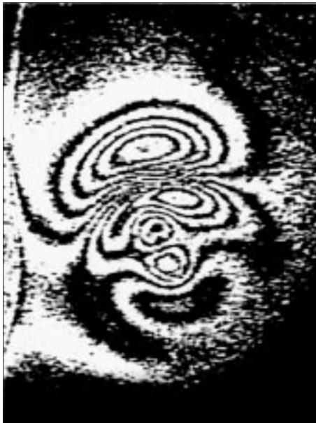
**Рис. 3.** Интерференционная картина, отображающая с повышением чувствительности изменения толщины плоского образца полиметилметакрилата и получения при совмещении пары голограмм бокового сдвига для  $\Delta s = \pm 0.6 \text{ mm}$ .
