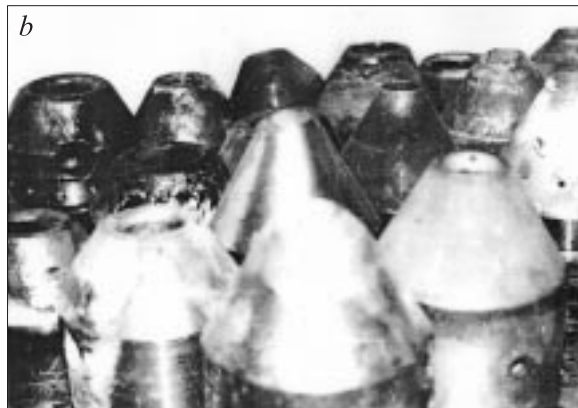
Рис. 2. Электроды разрядных камер: а — катоды, б — аноды.
