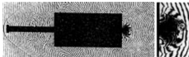
Рис. 4. Распространение зондирующей ударной волны в донной области, M = 2.34 . Справа показан увеличенный фрагмент интерферограммы, на котором видна зондирующая ударная волна.
