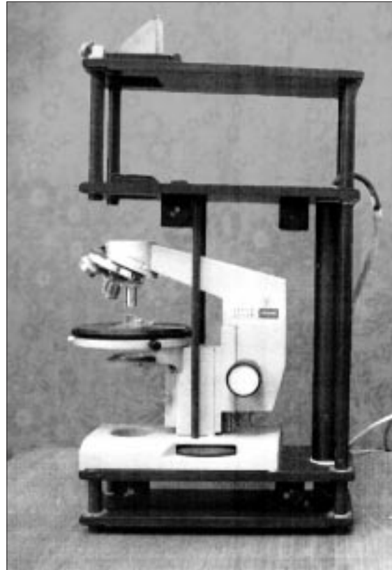
Рис. 1. Внешний вид конструкции голографического интерференционного микроскопа.
